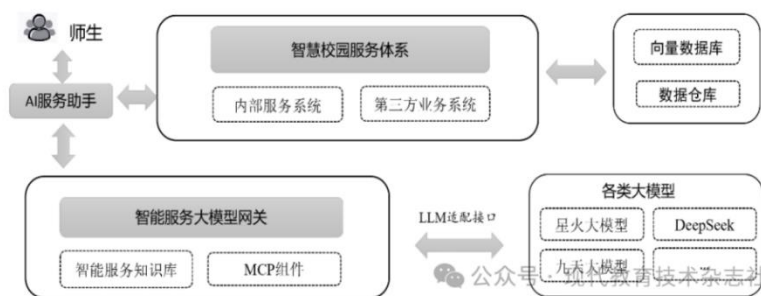
图3 智能服务大模型聚合网关的工作原理
